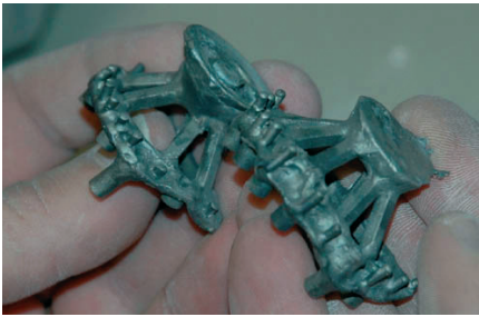
10. Se cuejan las estructuras con titanio y se limpian con óxido de aluminio.
