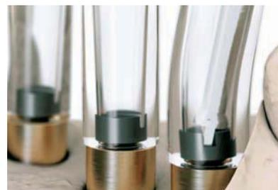
3. Fabricación de la supraestructura, incluyendo la posibilidad de angular los orificios de los tornillos.
